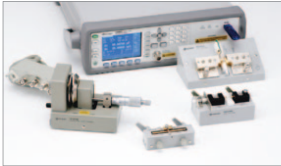
图 5. E4980AL LCR 表支持各种各样的测试夹具
